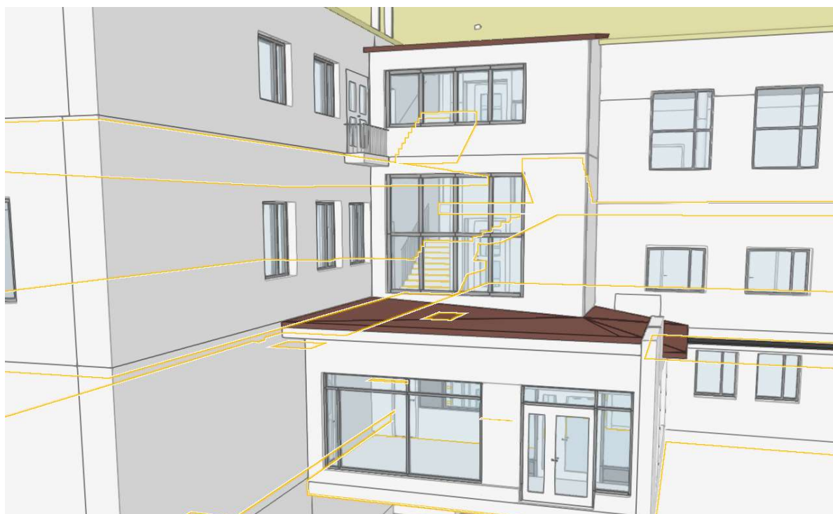
Kuva 2 - Ote rakennustietomallista, jossa korostettuna kerrokset 1-3 ja rappuset
